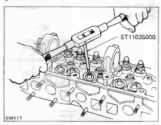
Fig. EM-34 Valve guide reaming
