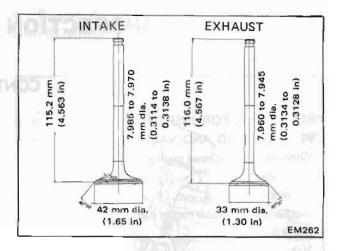
Fig. EM-30 Valve dimensions
