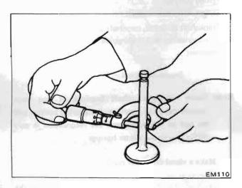
Fig. EM-28 Valve stem diameter check
