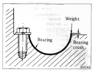
Fig. EM-60 Bearing crush check
