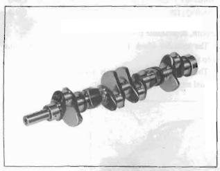
Fig. EM-3 Crankshaft
